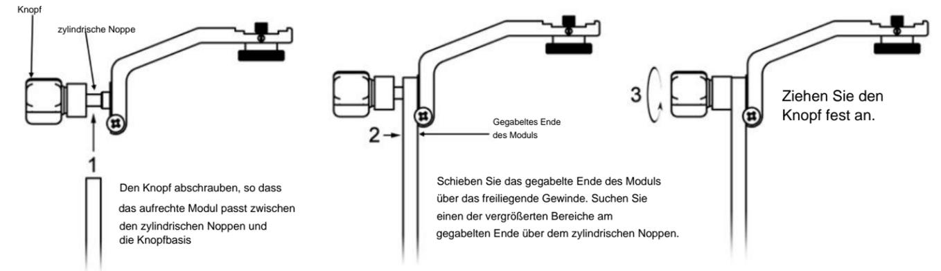
**Tipp:** Wenn Sie Schwierigkeiten beim Greifen der Metallknöpfe haben, versuchen Sie, mehrere Lagen selbstverschweißendes Gummi-Griffband (3M 2155) um den Knopf zu wickeln, um ihn abzufedern und ihn im Gelände leichter greifen zu können.
