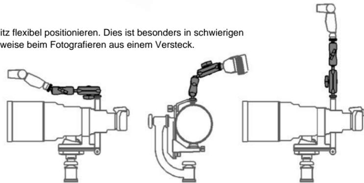
Der Makroarm (M-4) kann auch direkt mit dem Schnellwechselarm (M-1) verbunden werden. Dies wird häufig bei Makroanwendungen oder bei kleinen Kameras und Objektiven verwendet, bei denen das Aufrechtmodul nicht erforderlich ist.
